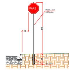
DETALHE INSTALAÇÃO DE PLACAS
