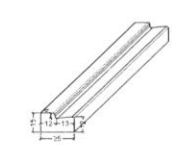
MEIO FIO TIPO 7 ESCALA 1:20
