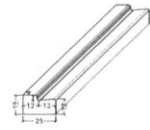
MEIO FIO TIPO 7 ESCALA 1:20
