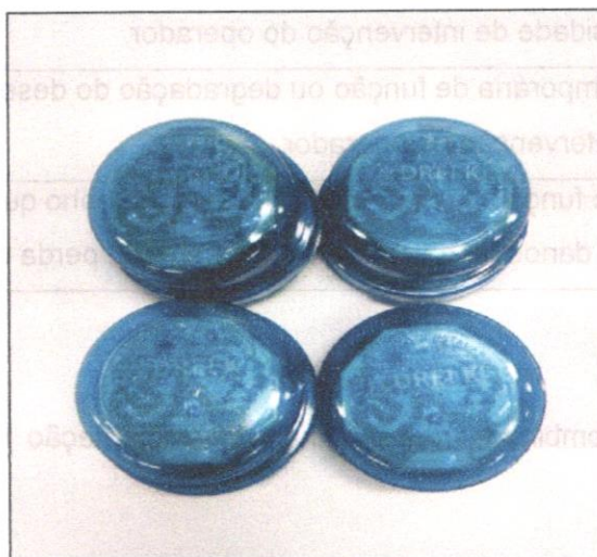
Figura 01 – Relés Fotoelétricos a serem ensaiados
