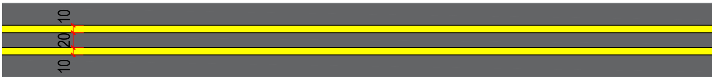
LFO-4 - LINHA CONTÍNUA / SECCIONADA
